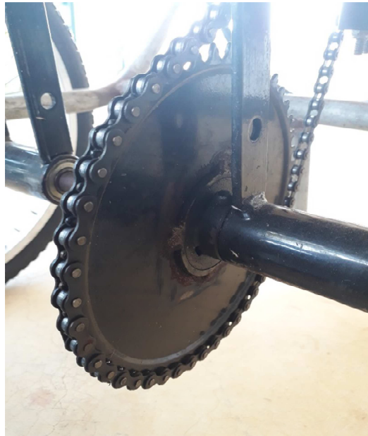
Figura 35 – Adaptação da engrenagem de 46 dentes ao diferencial
