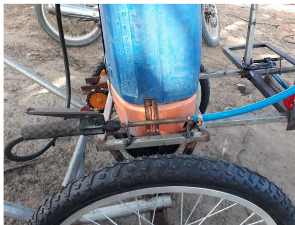
Figura 40 – Gatilho de acionamento do pulverizador costal manual acoplado ao sistema da barra de pulverização
