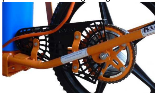
Figura 7 – Transmissão por correntes e engrenagens
